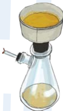
✓ 13 pav. Vakuminis pigmento filtravimas.
